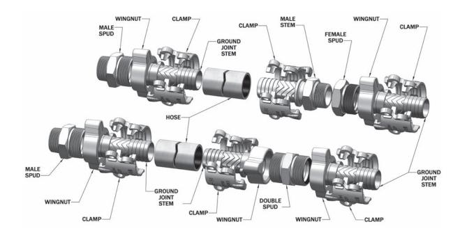
STEAM IS DANGEROUS. WE STRONGLY RECOMMEND THE USE OF GENUINE DIXON BOSS STEAM COUPLINGS AND CLAMPS. ONLY HOSE FITTINGS, CLAMPS AND ACCESSORIES APPROVED FOR STEAM SERVICE SHOULD BE USED.
