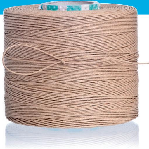
Um bei Fernmeldekabeladern einen gleichmäßigen Luftzwischenraum zwischen dem Leiter und der Papierisolierung zu erreichen, wird auf den Leiter unter der Papierumspinnung ein Papiergarn wendelförmig aufgesponnen.
