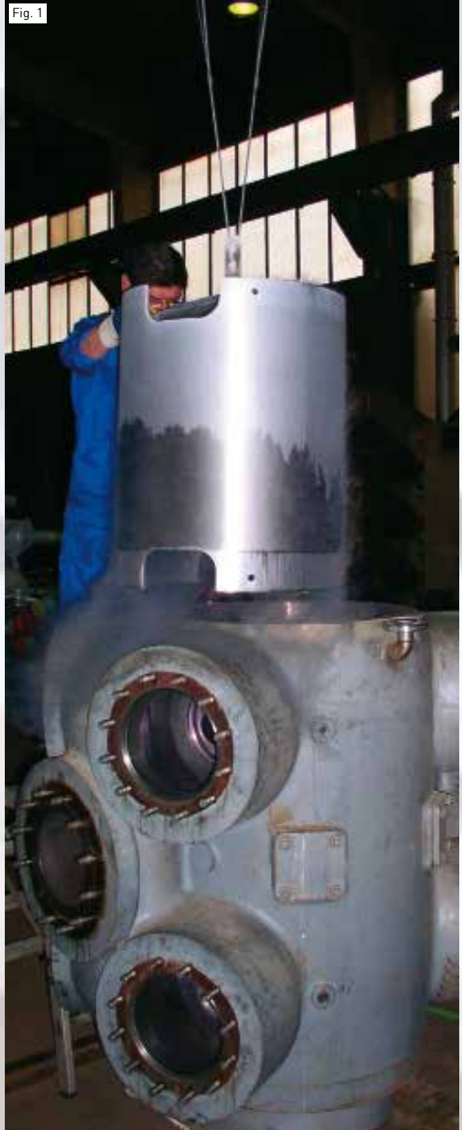
Fig. 1: Einschrumpfen einer Laufbuchse in einem Zylinder Shrinking of liner of a cylinder for a reciprocating compressor
